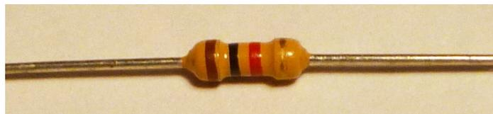
Abbildung 5.1: Ein Widerstand mit  $1\text{ k}\Omega$
