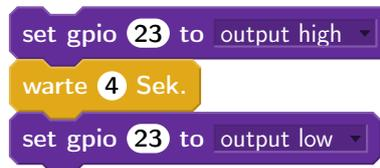
Abbildung 5.12: Pin 23 für 4 Sekunden einschalten
