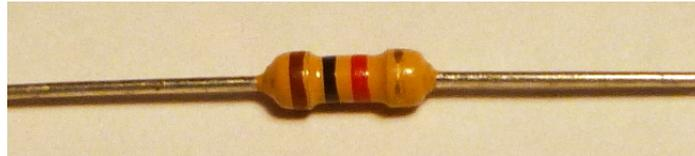
Abbildung 1: Ein Widerstand mit  $1\text{ k}\Omega$
